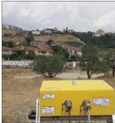
Lo strumento radar usato per tenere sotto controllo le frane
